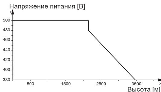
**Рис. 49** Питающее напряжение для трехфазного электродвигателя в зависимости от высоты над уровнем моря
