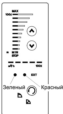
Рис. 42 Световые индикаторы на насосах с трёхфазными электродвигателями
