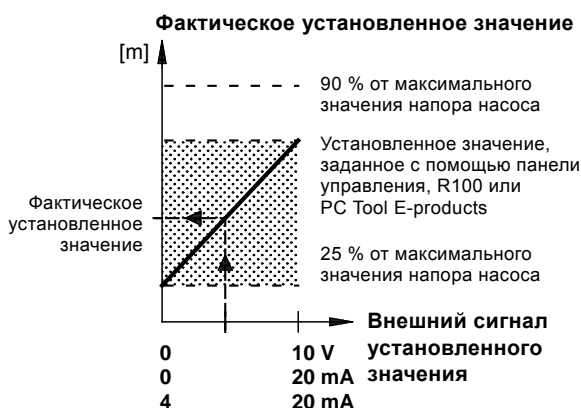
Рис. 38 Зависимость между фактическим значением и внешним сигналом установленного значения при режиме эксплуатации с пропорциональным регулированием напора
