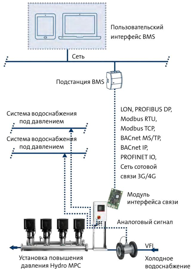
Пример установки Hydro MPC, подключённой к системе управления зданием (BMS).
