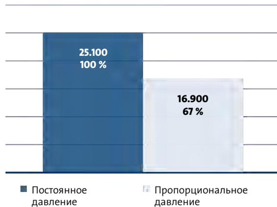
При эксплуатации установки повышения давления в режиме пропорционального давления годовая экономия электроэнергии в данном случае составляет 33%, несколько не ухудшая комфорт для потребителя.
