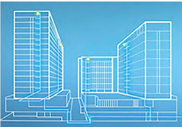
Пример коммерческого здания с широко разветвлённой системой водоснабжения. Может возникнуть трудность с определением контрольной точки, поэтому достаточно будет установить до шести датчиков давления, чтобы охватить всю систему.
